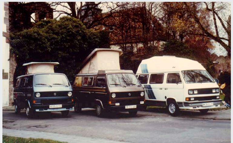
Drei Dachvarianten für den T3-Bulli: Universal-Hubdach, Aufstelldach und ein Aeroline-Hochdach.
