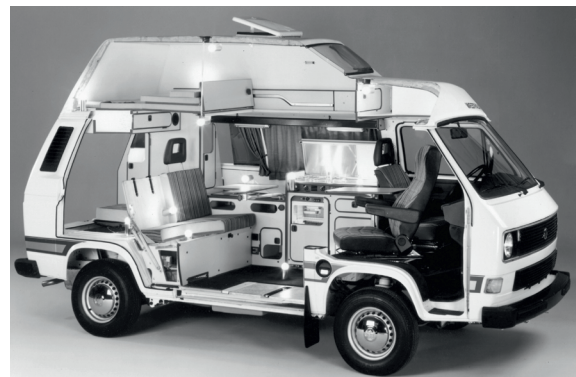
■ Für Fans einer der durchdachtesten Kastenwagenausbauten überhaupt: Westfalias Joker, hier das Schnittmodell mit Hochdach, auf der Basis des T3.
