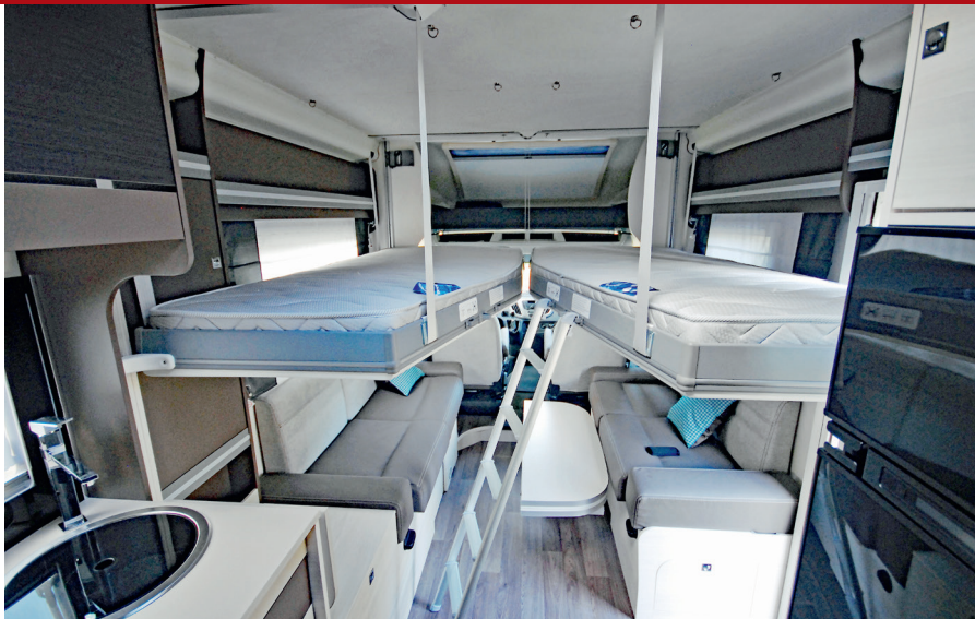
■ Der Clou im Chausson 630: Zwei elektrische, längs angeordnete Einzelbetten als Hubbetten.
