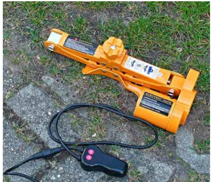
■ Der Scherenwagenheber mit Fernbedienung.
