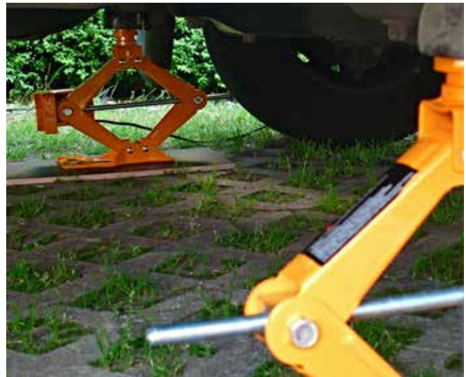
■ Vier Scherenwagenheber machen die Sache perfekt und können ein Hubstützensystem ersetzen.
